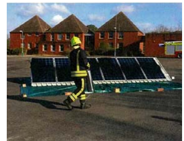
遮光剤を用いた 感電リスク低減技術
