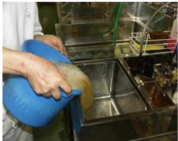
(10) 実証対象機器へ投入(下膳室排水)
