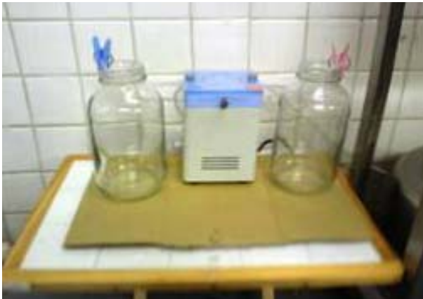
(15) ペリスタポンプ設置風景
