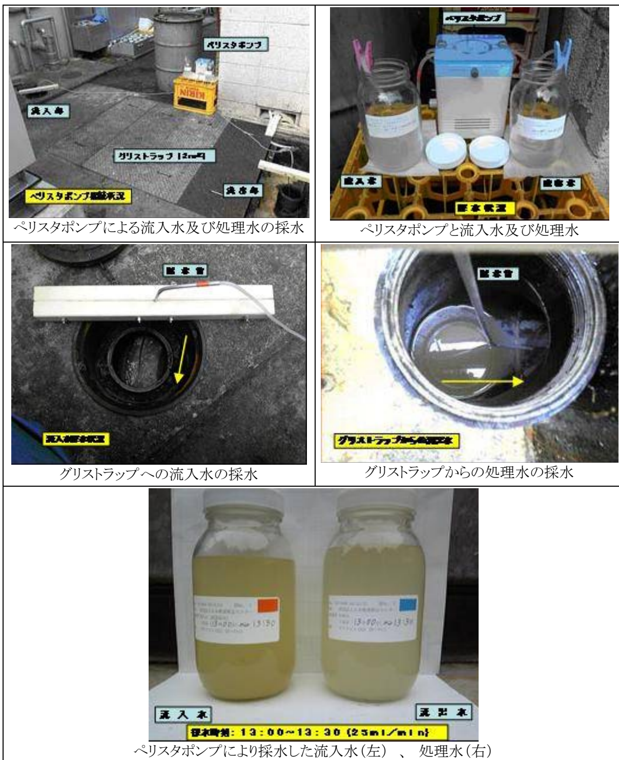
図 6 - 2 グリストラップの流入水及び処理水の採水状況
